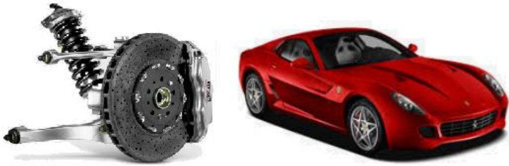
Figura 2: Suspensão automotiva MR do Ferrari 599 GTB Fiorano (Ferrari N.V., 2019).
