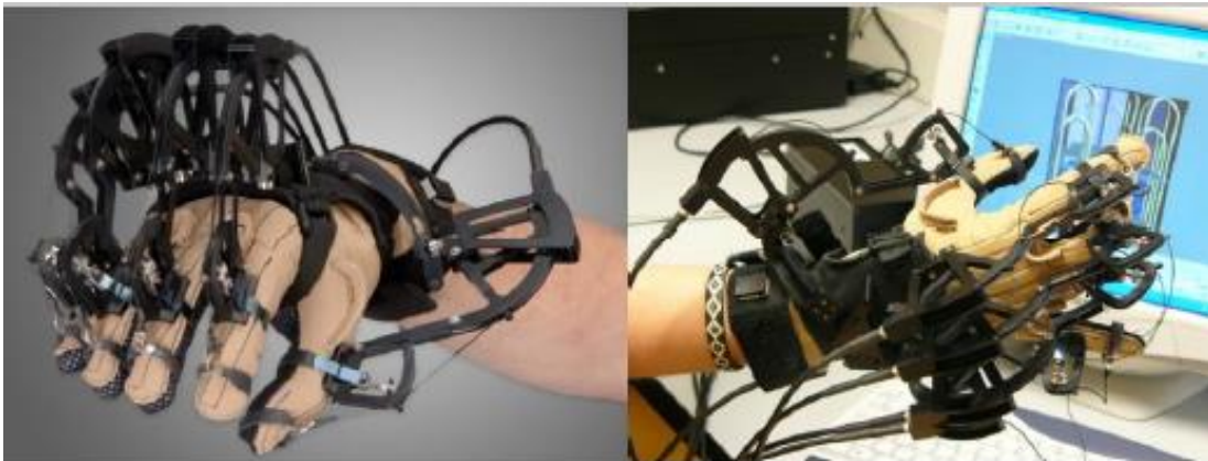
Figura 6: Luva CyberGrasp - Exemplo de dispositivo háptico (Soares, 2016).
